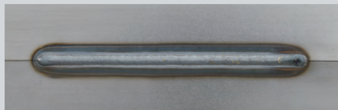
板厚0.8mm、溶接電流40A、 溶接電圧16V、ワイヤ径0.6mm、 溶接速度45cm/min
